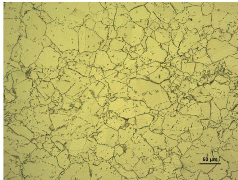
图A. 6 a) δ (Ni<sub>3</sub>Nb) 相可接受极限照片 (250X)
