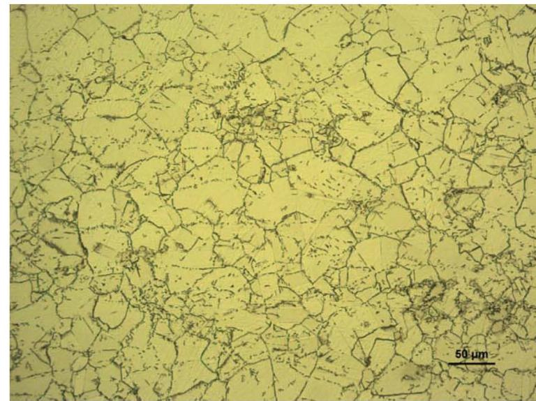
图A. 6 b) δ (Ni<sub>3</sub>Nb) 相不可接受极限照片 (250X)
