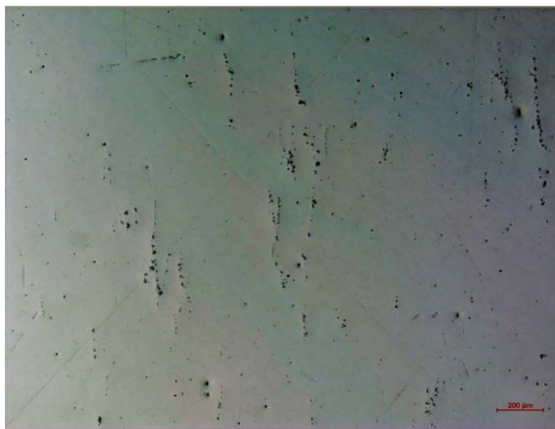
图A.5 网状碳化物标准极限照片（50X）
