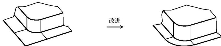
图6 减小法兰宽度
